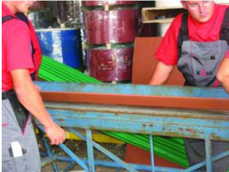
Рис.19. Изготовление планки на ручном гибочном станке
