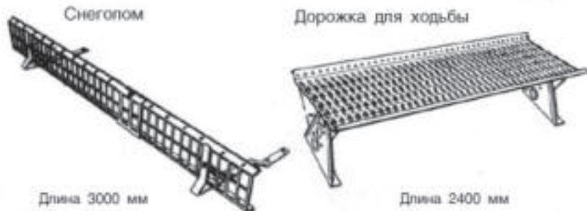
Рис. 82. Элементы безопасности: снегозадержатель и трап
