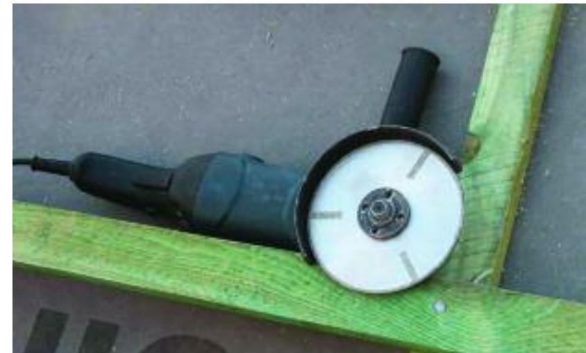
Рис.28. Инструмент для подрезания листов металлической черепицы
