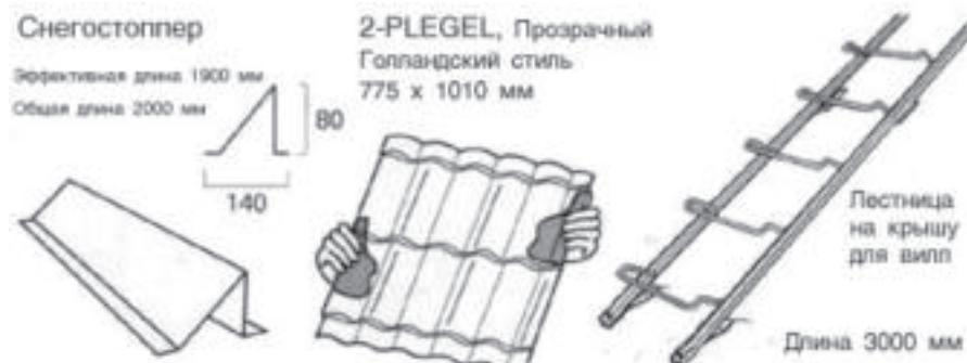
Рис. 81. Элементы безопасности: планка снегоуловителя и лестница
