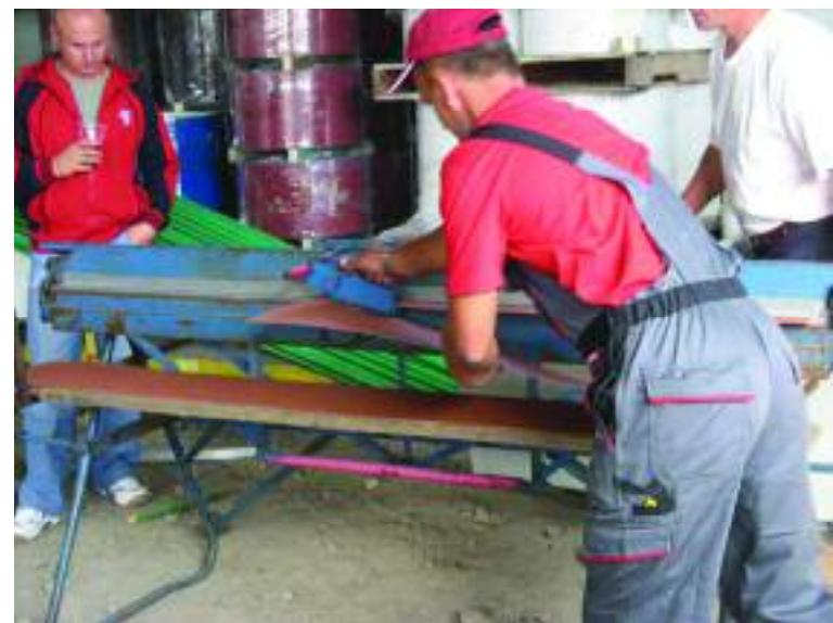
Рис.18. Разрезка плоского листа на штропсы
