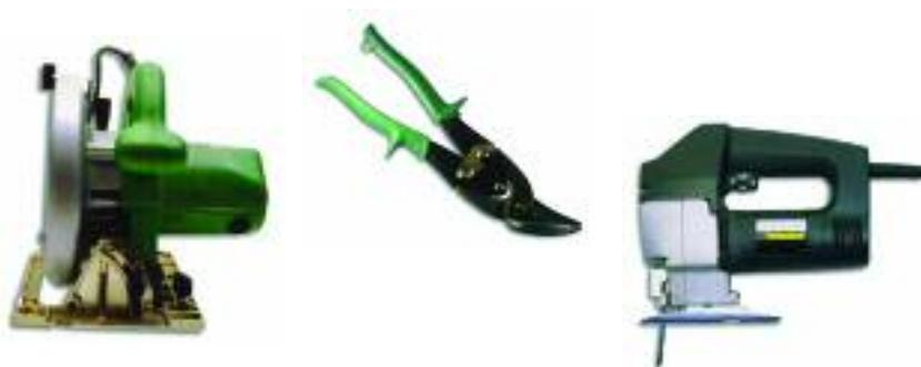
Рис.8. Инструмент для подрезки листов металличерепицы
